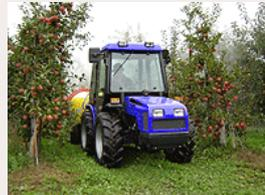
In der Standardausstattung haben ecopard Kompakttraktoren Allradantrieb, Servolenkung, ROPS-Überrollbügel, Komfortsitz mit Sitzgurt, eine Heckzapfwelle mit 540/1000 U/min, sowie einen 3-Punkt-Heckkraftheber. Die Zapfwelle liefert die erforderliche Leistung für den kraftvollen Antrieb aller Kategorie 1 und 2 Anbaugeräte.
